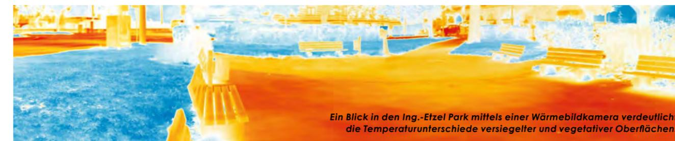
Ein Blick in den Ing.-Etzel Park mittels einer Wärmebildkamera verdeutlicht die Temperaturunterschiede versiegelter und vegetativer Oberflächen.
