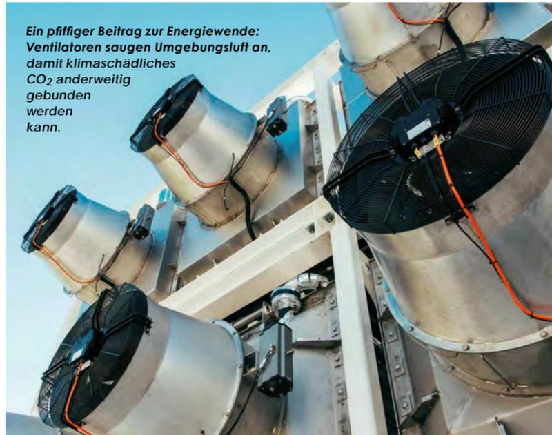
Ein pfiffiger Beitrag zur Energiewende: Ventilatoren saugen Umgebungsluft an, damit klimaschädliches CO<sub>2</sub> anderweitig gebunden werden kann.
