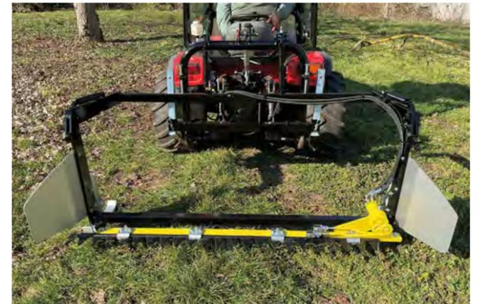
Der Mähbalken ist ökonomisch, da nur ein geringer Energiebedarf und Leistungsbedarf von Nöten ist. Somit können kleinere Schlepper eingesetzt werden, die die Bodenverdichtung verringern.
