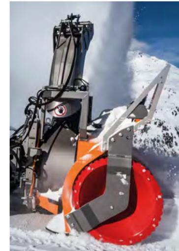
Durchmesser von 114 Zentimetern aus gehärtetem Qualitätsstahl sind mit Abschaltkupplungen abgesichert. Seitenlager garantieren zusätzliche Stabilität bei hartem und eisigem Schnee. Das Schleuderrad mit einem Durchmesser von 125 Zentimetern ist durch die Gelenkwelle gesichert.
