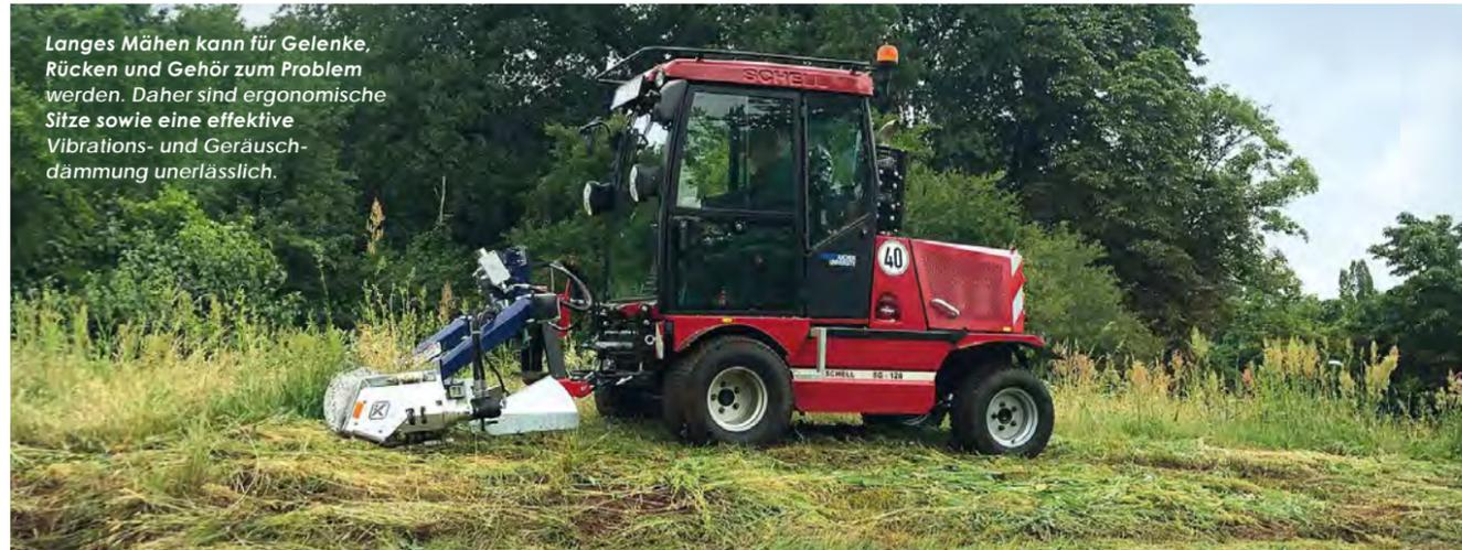
Langes Mähen kann für Gelenke, Rücken und Gehör zum Problem werden. Daher sind ergonomische Sitze sowie eine effektive Vibrations- und Geräuschdämmung unerlässlich.
