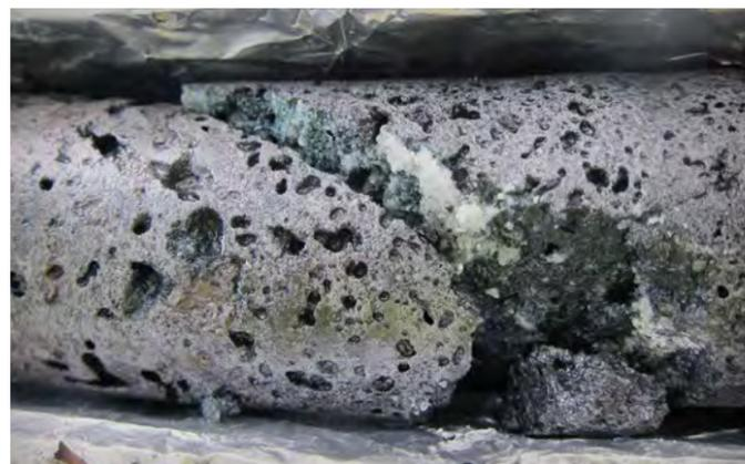
In Basalt bildet CO<sub>2</sub> Calcit, auf diese Weise wird das Treibhausgas gebunden (links). Der Versuchsreaktor zur Methanspaltung ist eine Vorrichtung aus Quarz und Edelstahl, in der sich geschmolzenes Zinn befindet (rechts). Dort steigen Methanbläschen auf, in denen die Cracking-Reaktion stattfindet. Der Reaktor ist Teil des Karlsruhe Liquid Metal Laboratory, um Technologien zum Einsatz von Flüssigmetallen zu entwickeln.
