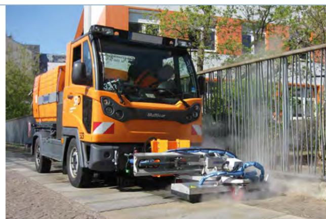
des Brenners je nach Ausbringgerät. Der Brenner geht bei kurzen Arbeitspausen automatisch in Stand-by-Modus. Die installierte Anwendung auf dem abgebildeten Fahrzeug ist mit einem Gießarm ausgestattet, um die Doppelnutzung zu veranschaulichen. Das Arbeiten im Gießmodus ist voll regelbar mit Mengenregulierung und Dosierzähler 70 Litern pro Minute bei 5 bar Wasserdruck möglich.
