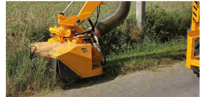
die Konstruktion durch die optionale Anbringung eines Absaugschlauchs oder Förderbands, wodurch das Mähgut abgefördert und der Boden für eine reiche Vegetation vorbereitet werden kann. Der Mäher hat eine Arbeitsbreite von 160 Zentimetern und benötigt eine Hydraulikleistung von 120 Litern pro Minute bei 250 bis 350 bar. Der Mäher bringt ein Eigengewicht von 630 Kilogramm auf die Waage.
