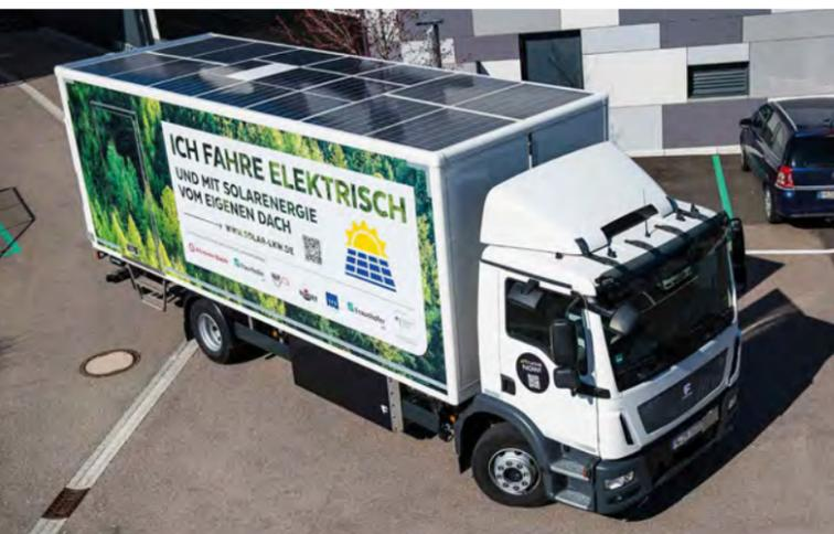
PV-Integration in einen Demo-E-LKW: Das Fahrzeug hat 3,6 Kilowatt Peak auf dem Dach und kann am Tag 18 Kilowattstunden nachladen. Bei der Batteriekapazität von 160 Kilowattstunden bedeutet das, dass elf Prozent der Batterie am Tag nachgeladen werden können, natürlich abhängig vom Sonnenstand.
