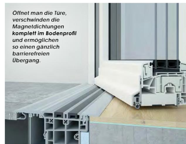
Öffnet man die Türe, verschwinden die Magnetdichtungen komplett im Bodenprofil und ermöglichen so einen gänzlich barrierefreien Übergang.
