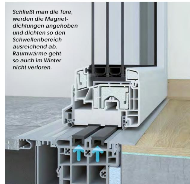
Schließt man die Türe, werden die Magnetdichtungen angehoben und dichten so den Schwellenbereich ausreichend ab. Raumwärme geht so auch im Winter nicht verloren.
