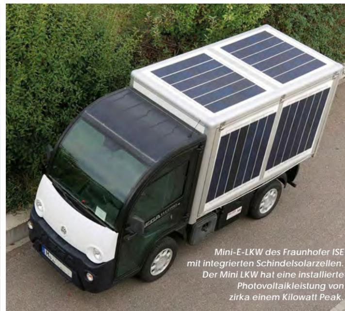
Mini-E-LKW des Fraunhofer ISE mit integrierten Schindelsolarzellen. Der Mini LKW hat eine installierte Photovoltaikleistung von zirka einem Kilowatt Peak.
