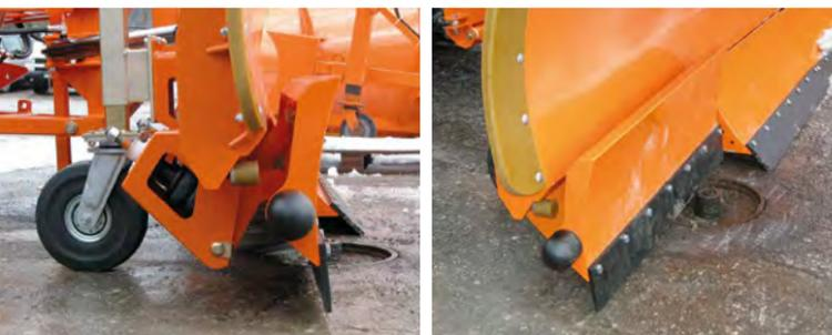
Das Elementabfederungssystem mit Einzelhebelaufhängung ermöglicht eine optimale Anpassung an das Fahrprofil und gewährleistet ein sicheres Überfahren von Unebenheiten auch bei hoher Geschwindigkeit.
