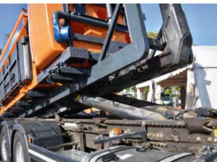
Die Aufnahme des Streuautomaten auf einem Abrollkipper geschieht in wenigen Minuten. Das bringt maximale Flexibilität.
