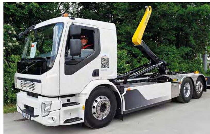
Im Frühjahr 2022 präsentierte Volvo Trucks auf der IFAT (links) seinen Volvo FE Electric mit Hiab Multifilt-Hakengerät. Rechts ist der Volvo FE Electric als Dreiaxser zu sehen, dessen Palfinger-Hakenabrollgeräte sauber und leise seine Behälter aufnimmt.
