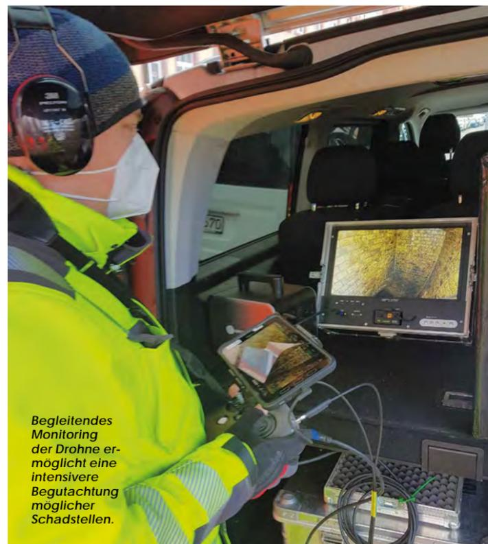
Begleitendes Monitoring der Drohne ermöglicht eine intensivere Begutachtung möglicher Schadstellen.
