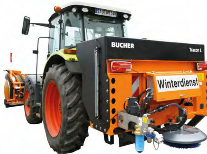
Der Sole-Streuautomat Tracon L ist in verschiedenen Behältergrößen für Traktoren verschiedenster Marken und Größen verfügbar. Der Bürstenteller bringt Sole vollflächig von bis zu sechs Metern aus.
