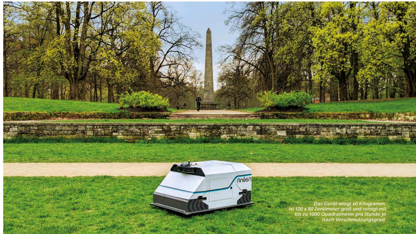
Das Gerät wiegt 60 Kilogramm, ist 120 x 80 Zentimeter groß und reinigt mit bis zu 1000 Quadratmeter pro Stunde je nach Verschmutzungsgrad.
