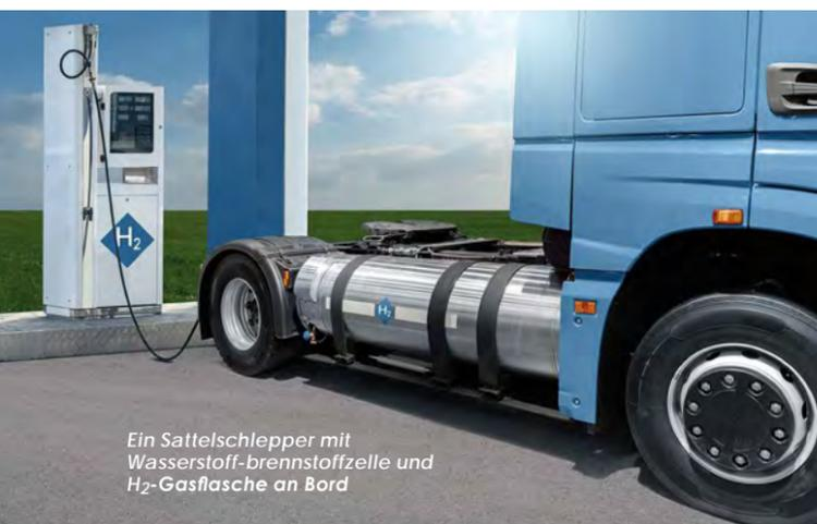
Ein Sattelschlepper mit Wasserstoff-brennstoffzelle und H<sub>2</sub>-Gasflasche an Bord
