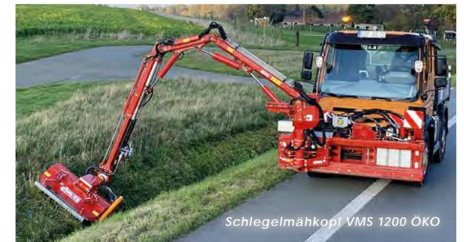
Der Schlegelmähkopf wird über einen Zahnriemenantrieb angetrieben. Er ist wahlweise für rechts- oder linksarbeitend lieferbar und mit einer auswechselbaren Verschleißhaube ausgerüstet. Die Lager der Schlegelwelle sowie der Tastrolle sind wartungsfrei.
