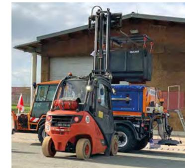
Der VarioMax kann einfach und zügig ein- und ausgebaut werden.
