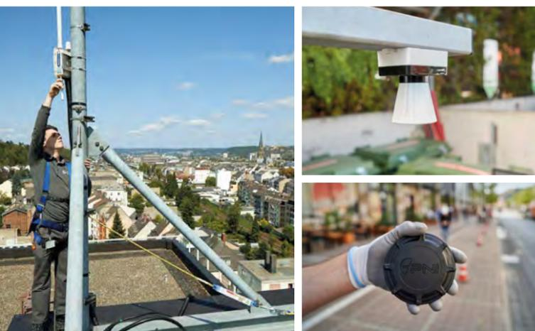
Links: Ein Ziel ist es, den Landkreis Mayen-Koblenz flächendeckend mit LoRaWAN auszustatten. Rechts oben: Mit Füllstandssensoren kann überprüft werden, ob Abfallbehälter bereits voll sind oder noch Platz für Müllsäcke bieten. Rechts unten: Mit Hilfe eines Bodensensors im Boden kann ermittelt werden, ob ein Parkplatz schon frei oder noch besetzt ist.
