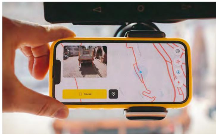
Ist das vialytics-Smartphone an der Windschutzscheibe befestigt, wird die Streckenaufzeichnung mit einem Klick gestartet.
