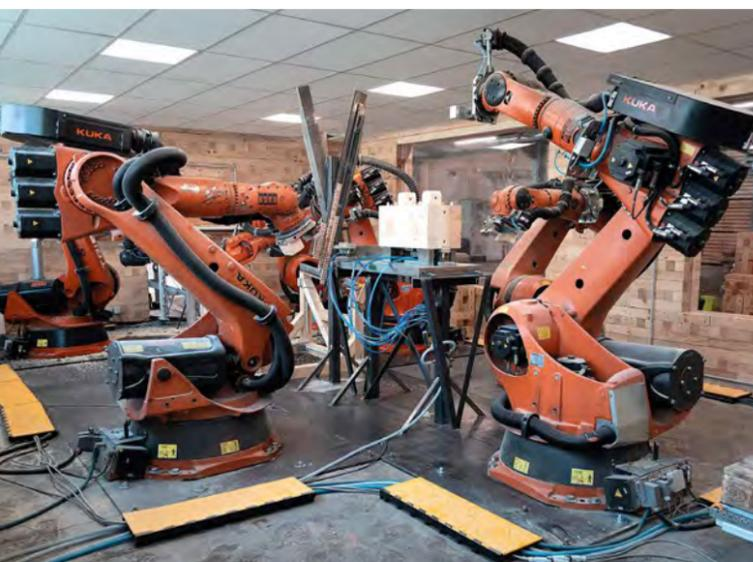
Der Kern der Triqbriq-Produktion besteht aus Robotern. Diese verarbeiten die vorgehobelten Kanthölzer entlang eines patentierten dreiaxialen Dübel-Systems zu statisch einwandfreien Briqs.
