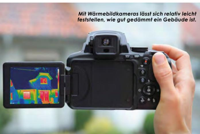
Mit Wärmebildkameras lässt sich relativ leicht feststellen, wie gut gedämmt ein Gebäude ist.
